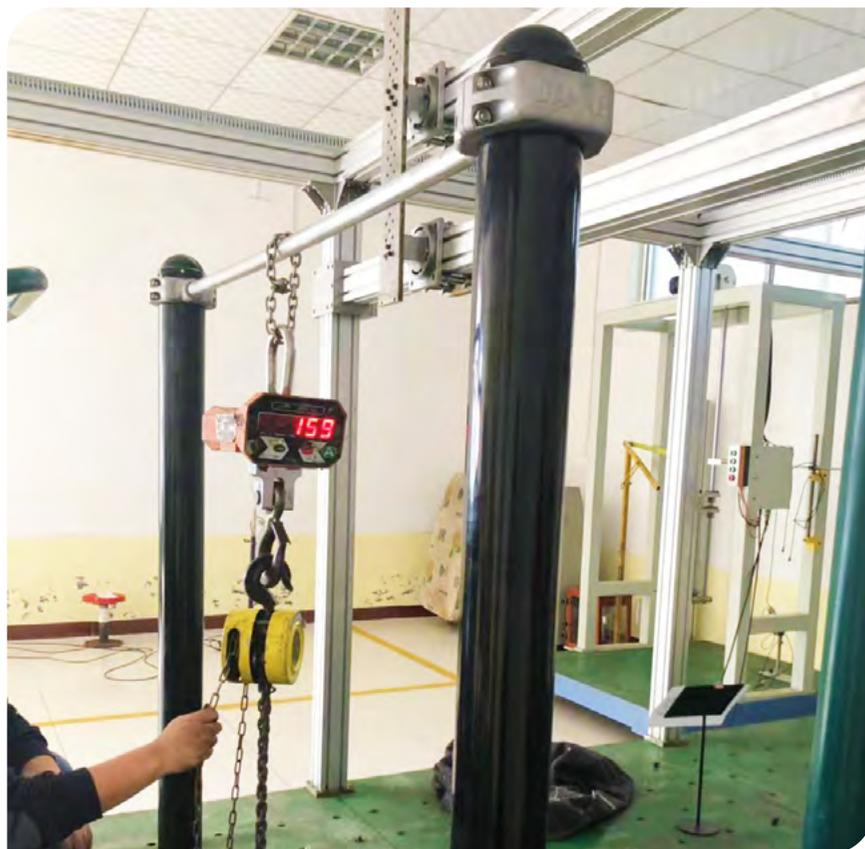
Chargée en son point le plus faible, la plus longue de nos barres (2 mètres) supporte la charge **jusqu'à 1 tonne** ! L'acier se déforme mais le système ne cède pas !
